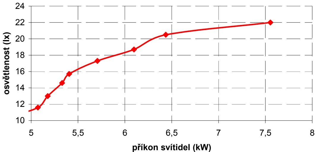
Obr. 3 Průběh osvětlenosti v závislosti na příkonu svítidel – lokalita 2: RVO osvětlení napojeno na měření z RVO 909 (Ulice Studentská, VTP).
